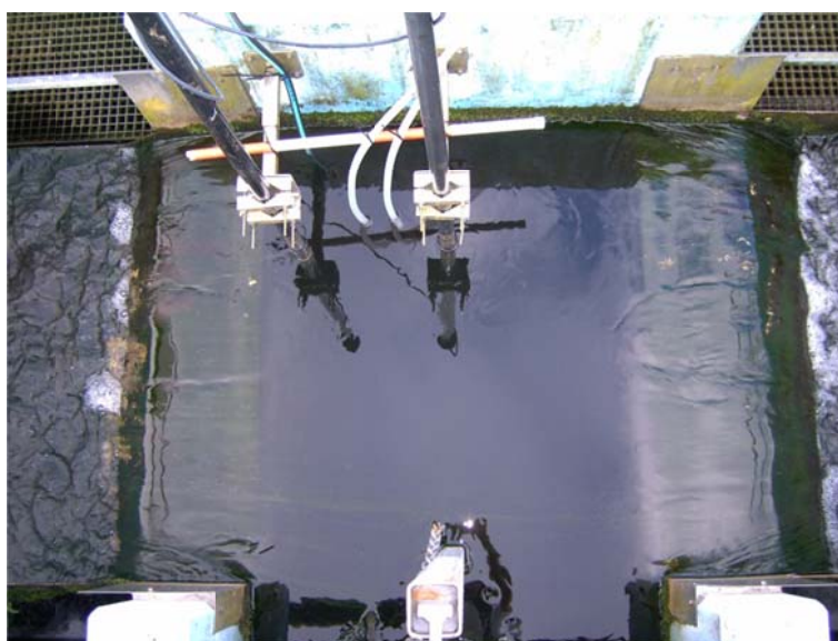
Figur 4 Udtagningssted for døgnprøver i afløb fra Vejen Renseanlæg. De to lyse slanger er referencelaboratoriets prøvetagere. Desuden ses slange fra renseanlæggets egen prøvetager og to sonder til kontinuert måling.
