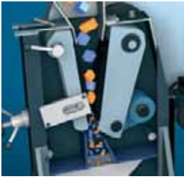
Figur 4. Knusning af jord i kæbeknuser, Retch Jaw Crusher BB51 (procedure 3).
