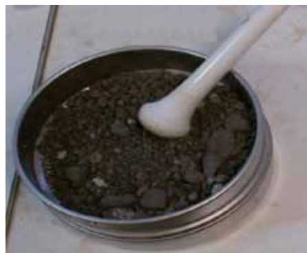
Figur 1. Sigtning på 2 mm sigte (procedure 2).
