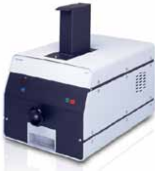
Figur 4. Knusning af jord i kæbeknuser, Retch Jaw Crusher BB51 (procedure 3).
