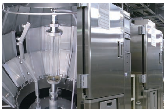
所有設備例 上：アドバンスセーフティーテスター 下左：サンシャインウェザーメーター 下右：環境試験槽
