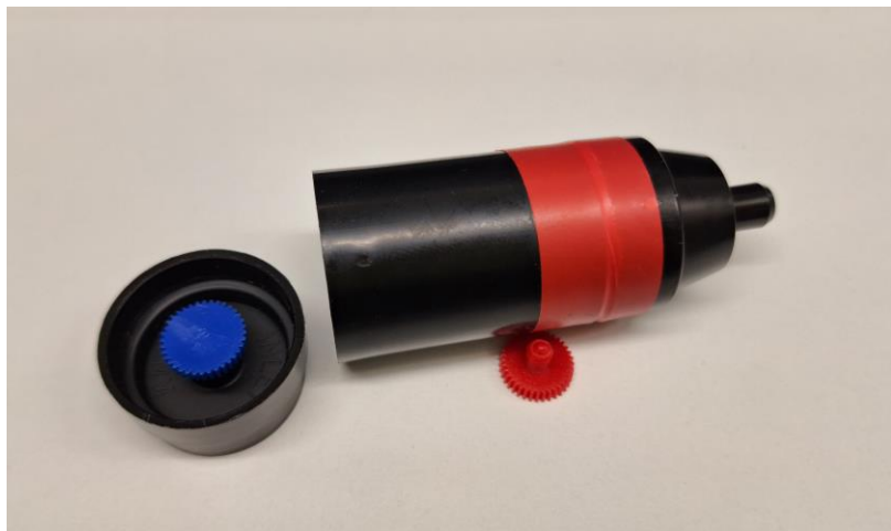
Kuva 1. 25 mm keräinkasetti, josta on irrotettu korkkiosa sekä päätykorkki.
